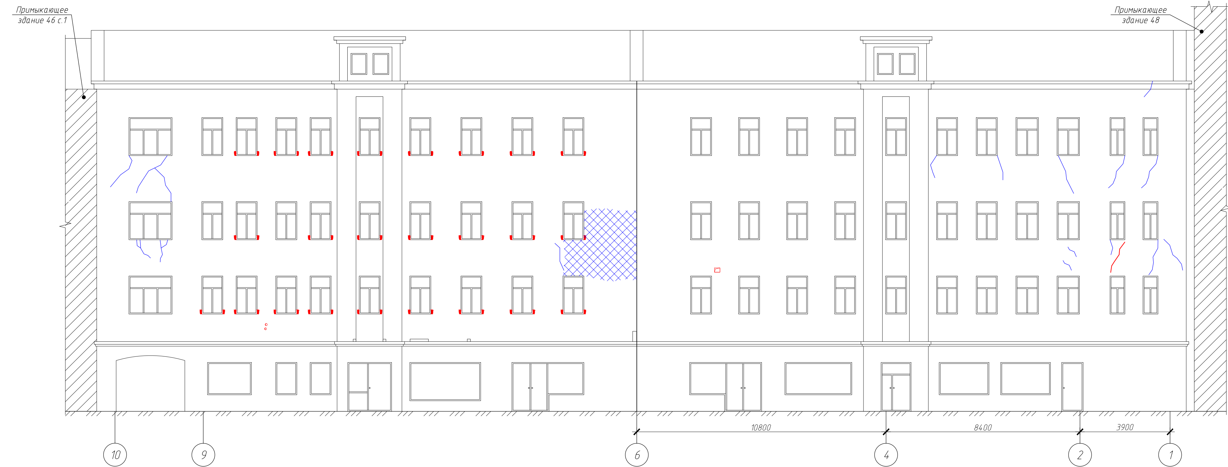
Эскизный чертеж фасада в осях 10-1 с нанесенными дефектами
